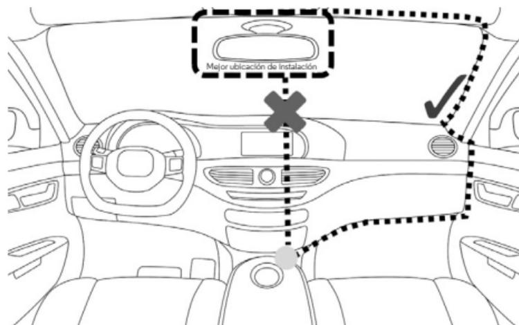
*La ilustración anterior refleja un coche con el volante a la izquierda. Si el coche tiene el volante a la derecha, invierta la posición de instalación del cable.*
