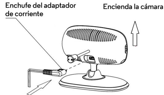
1. Inserte el enchufe del adaptador de corriente a la toma micro USB de la parte trasera de la unidad de cámara.
